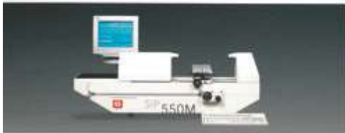
Figure 1. Une modernisation de l'électronique des machines de mesure de la longueur rétablit la puissance d'origine. (© my-métrie)
